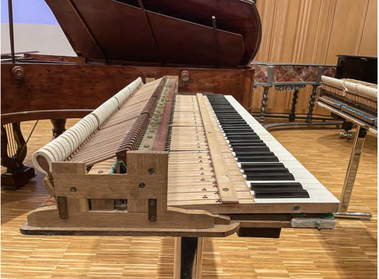
Stoßmechanik des originalen Hammerflügels von Ignace Pleyel (1851), der vom Cembalo- und Hammerflügelbauer Christoph Kern restauriert wurde.
